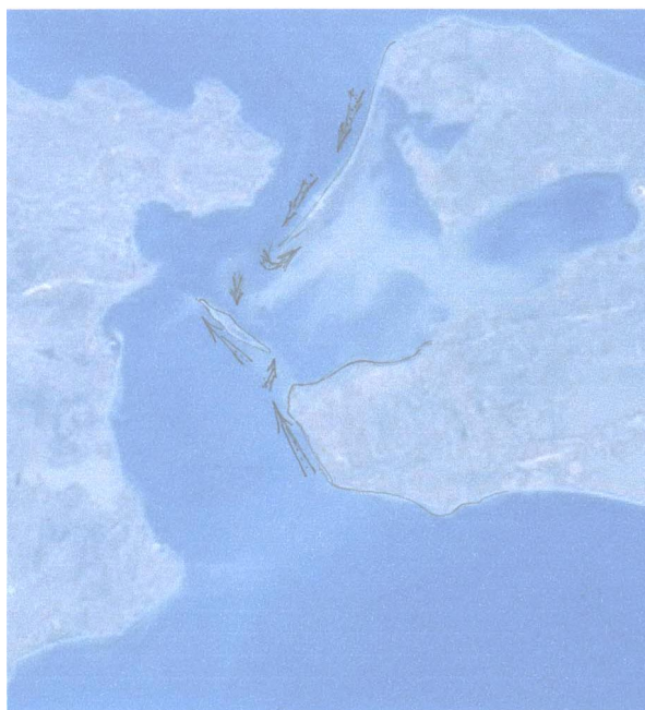
Рис. 1. Литодинамика района о. Тузла до строительства дамбы
