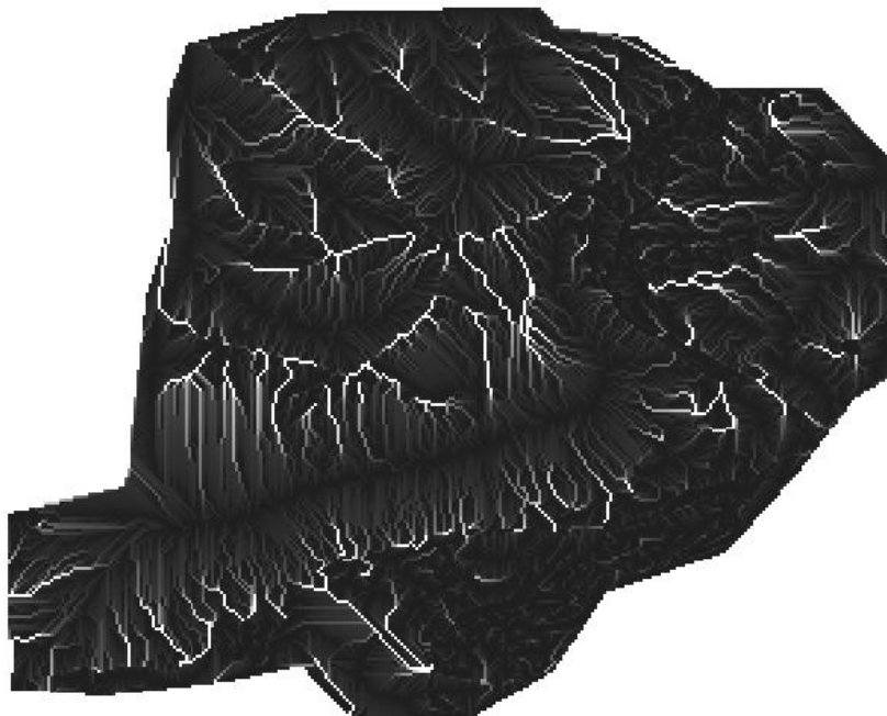
Рис. 4. Грид кумулятивного стока ЦМР без обработки функцией Fill
